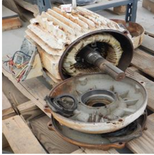
Asenkron motorda gövde ve kapak
